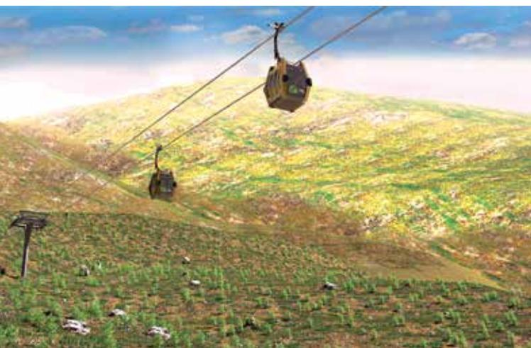
Las cabinas son de acero galvanizado con lunas de policarbonato. El recorrido desde el andén de salida hasta el de llegada será de 20 minutos.
